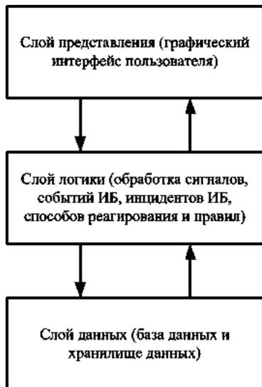
Рис. 6. Архитектура программной модели управления событиями ИБ
