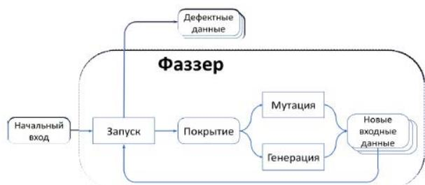
Рис. 2. Принципиальная схема фаззинга
