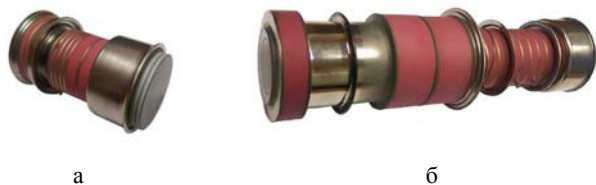
Рис. 5. Хронографические ЭОП: а – ТПО29, б – ТПО30-01, [6]
