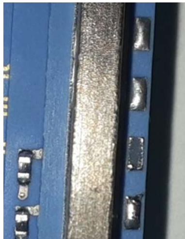
Рис. 1. Фотография участка смонтированной МКП с растворенной КП
