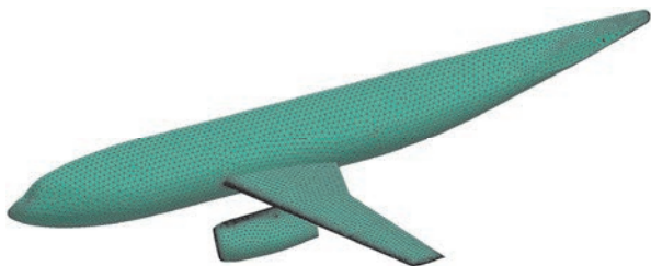
Рис. 1. Фрагмент исходной сетки
