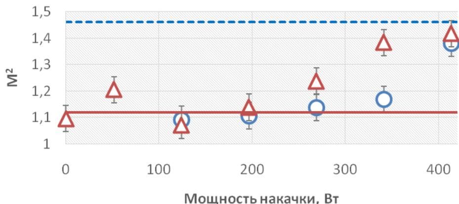
Рис. 4. Зависимость  $M^2$  от мощности накачки охлаждения с обеих сторон, пучок  $2,4 \times 0,4$  мм. На графике треугольниками обозначены измерения по оси  $y$ , сплошной линией соответствующий расчет для мощности накачки 400 Вт, кругами обозначены измерения по оси  $x$ , пунктирной линией соответствующий расчет для мощности накачки 400 Вт
