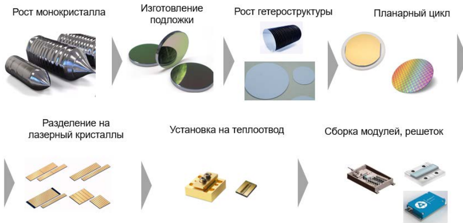
Рис. 2. Схема изготовления полупроводниковых инжекционных (диодных) лазеров
