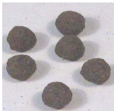
Рис. 5. Остатки шаровой мишени. Пятно фокусировки 160 мкм. E = 51,8 Дж. T = -22^\circ\text{C}
