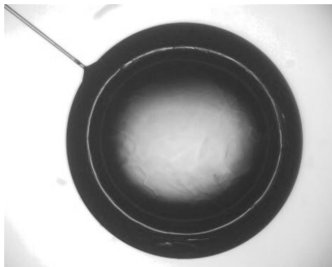
Рис. 10. Результат эксперимента по формированию криослоя дейтерия
