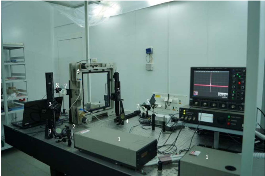
Рис. 3. Фото стенда для измерения угла синхронизма: 1 – лазер с \lambda = 1053 нм, 2 – полупрозрачная пластина, 3 – зеркала, 4 –фокусирующая линза, 5, 8 – измерители энергии, 6 – моторизированная оправа, 7 – светофильтр
