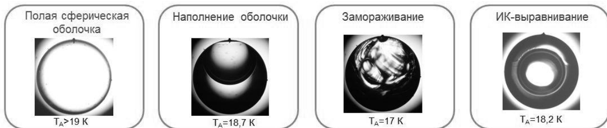
Рис. 7. Этапы формирования криогенного слоя изотопов водорода в оболочке
