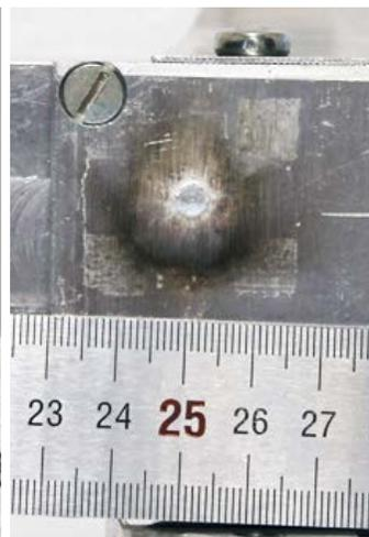
Рис. 11. Фотография места крепления конусной мишени после опыта
