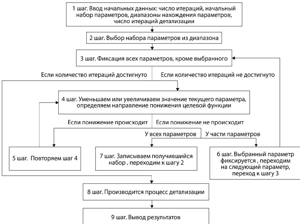
Рис. 4. Схема вычислений метода SLS
