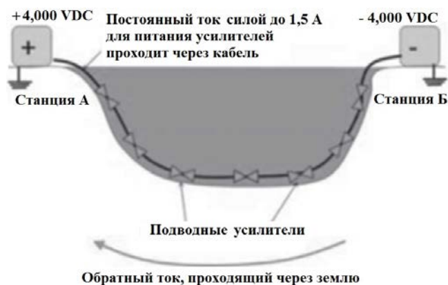
Рис. 8. Питание подводных оптических усилителей [12]
