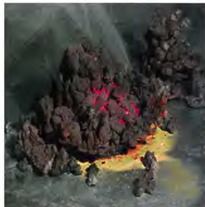
Горение открытого заряда диаметром 60 × 50 мм из ВВ на основе ТАТБ
