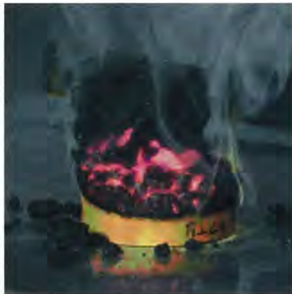
Горение открытого заряда диаметром 60 × 50 мм из ВВ на основе ТАТБ
