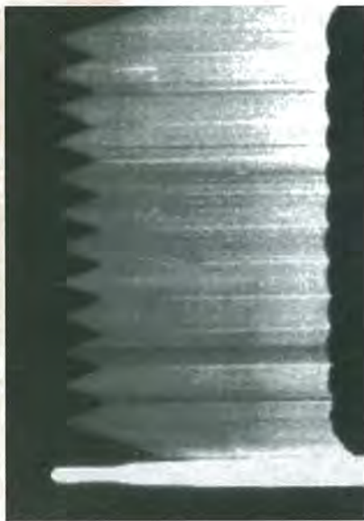
Рис. 9. Лидерное инициирование ЖВВ двенадцатью параллельно включенными разрядниками. Межэлектродное расстояние 0,2 мм. Яркое свечение внизу — реперная отметка (пробой обостряющего разрядника)
