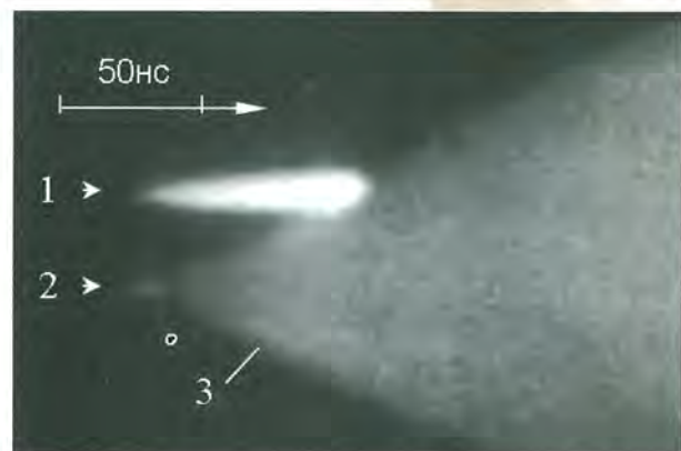
Рис. 7. Иницирование ЖВВ незавершённым искровым разрядом: 1 — завершённый разряд; 2 — незавершённый; 3 — детонация
