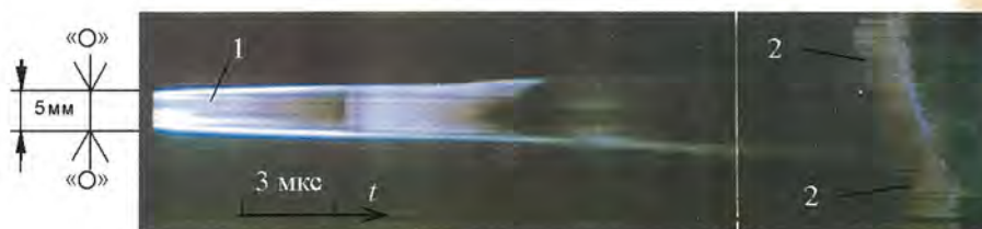
Рис. 3. Ударно-волновое иницирование жидких ВВ: 1 — свечение канала разряда; 2 — фронт детонации; «О-О» — форма электродов в виде острия, расстояние между электродами 5 мм; цель фоторегистратора вдоль оси электродов; t — направление развертки
