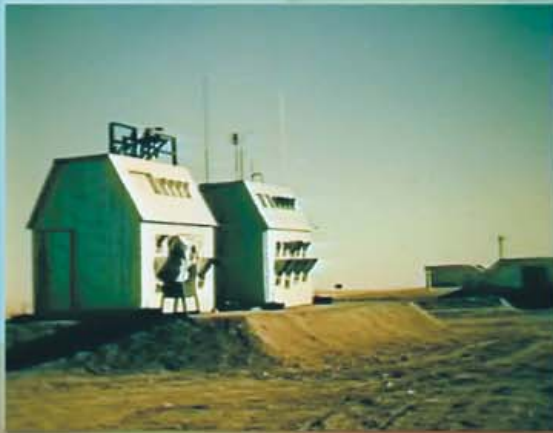
Сооружения для проведения оптических измерений параметров "огненного шара" взрыва
