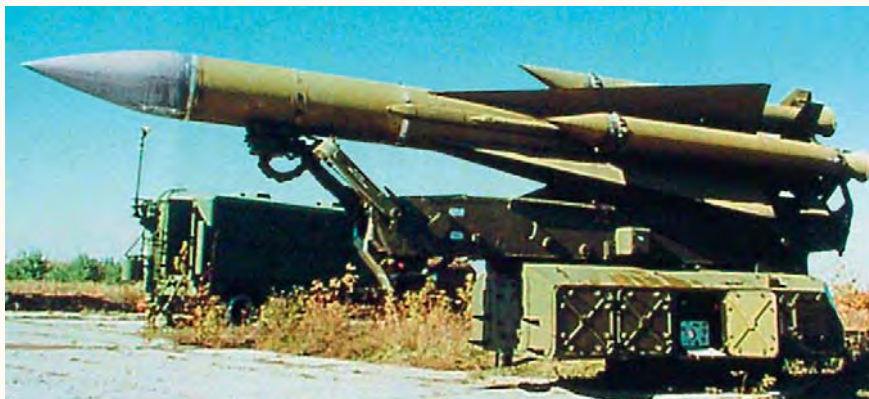
Зенитно-ракетная система С-200, оснащенная ракетой 5В28МН
