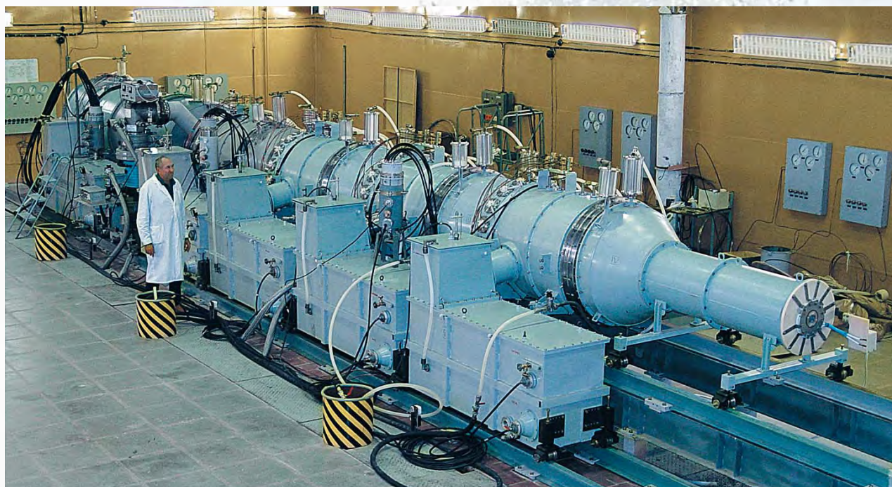
Рис. 2. Первая очередь ускорителя пучка электронов ЛИУ-Р с энергией до 30 МэВ, током 10–20 кА, длительностью 50 нс
