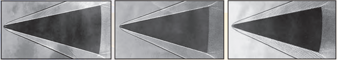
Рис. 2. Теневой спектр обтекания модели
