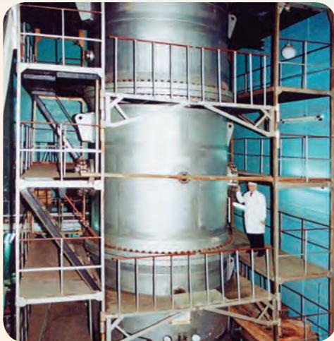
Электростатический перезарядный генератор (тандем) ЭГП-10 является прецизионным ускорителем заряженных частиц, который обеспечивает возможность ускорения частиц любой массы и заряда и позволяет измерять и поддерживать энергию этих частиц с очень высокой точностью.
