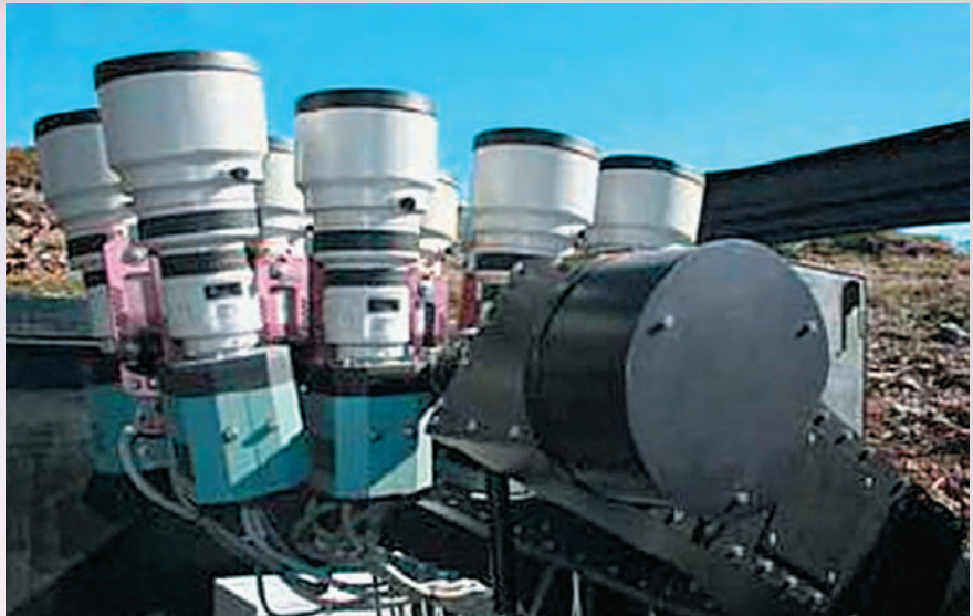
Один из роботов-телескопов сети «RoboNet». Эффективный диаметр зеркала два метра получается в результате сложения данных, полученных восемью маленькими телескопами
