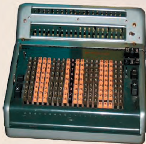
Клавишная вычислительная машина «Мерседес»
