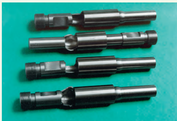
Рис. 5. Общий вид разрушенных после испытаний макетов термомеханического соединения трубопроводов муфтами из никелида титана
