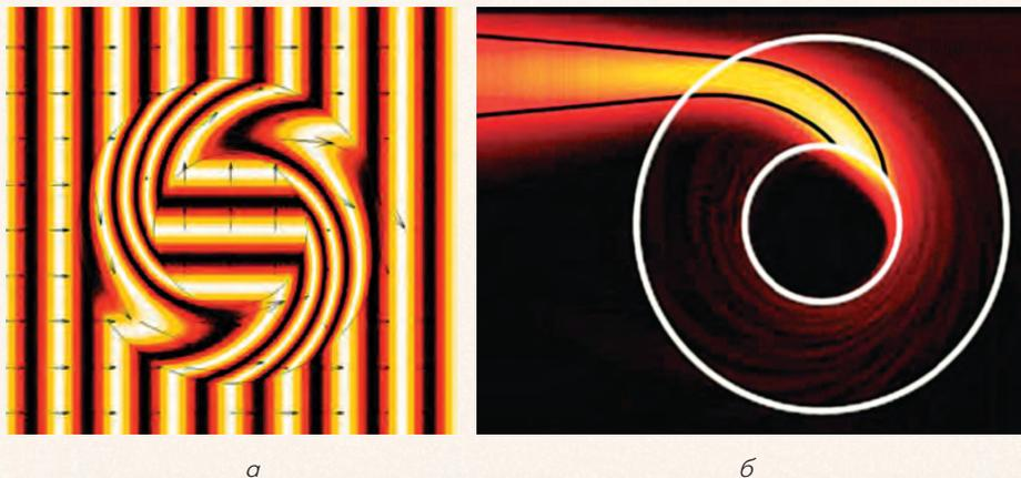
Рис. 13. Электромагнитная модель черной дыры: а — распределение амплитуды электрического поля в оболочке типа ротатор; б — моделирование поглощения волны на «линии горизонта»
