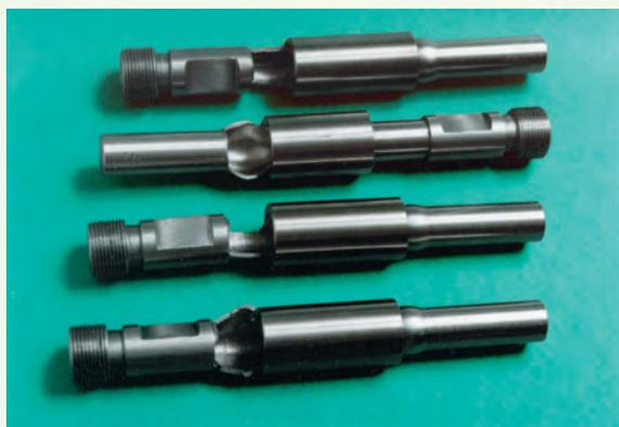
Рис. 5. Общий вид разрушенных после испытаний макетов термомеханического соединения трубопроводов муфтами из никелида титана
