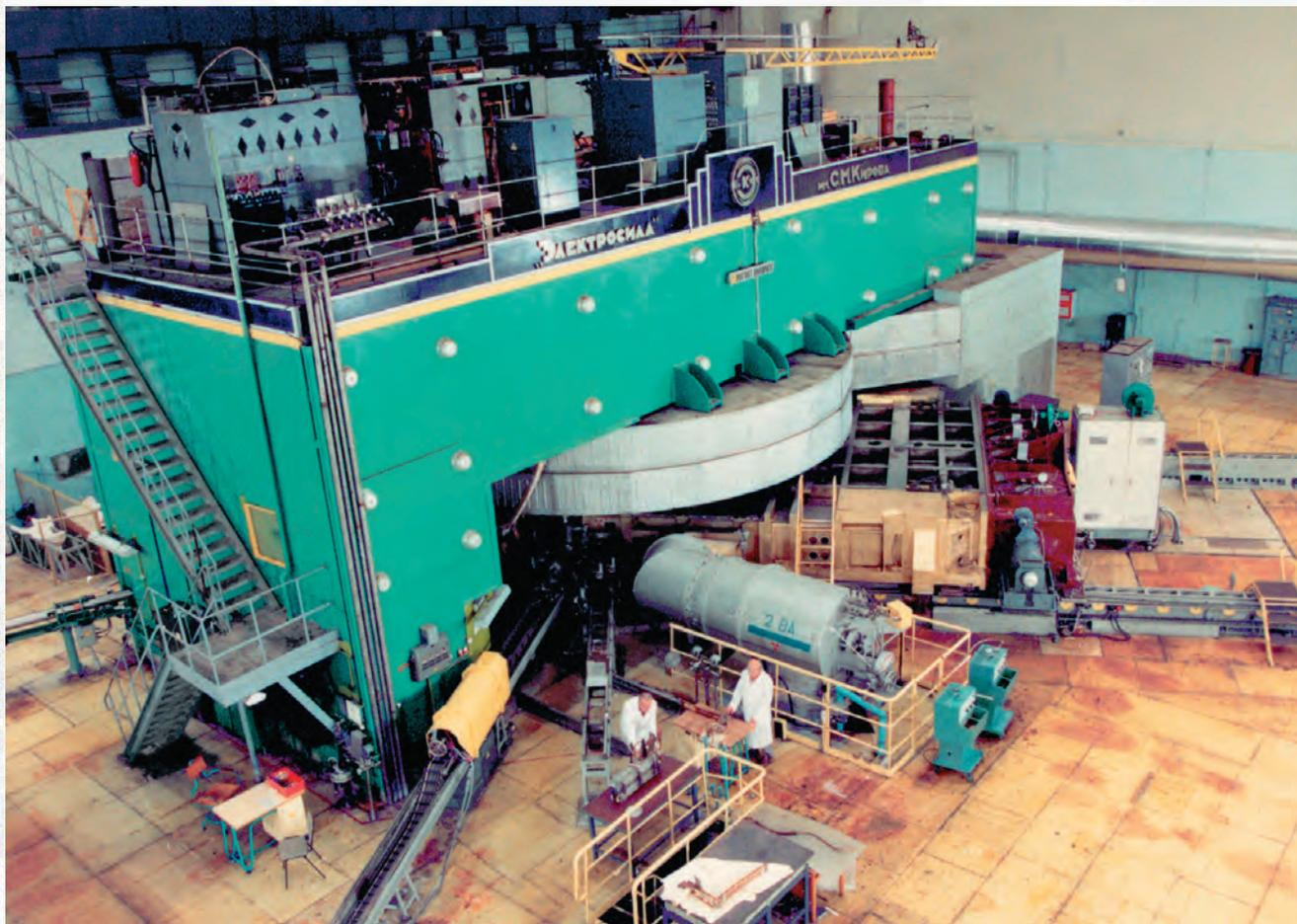
*Ускоритель протонов — фазотрон*
