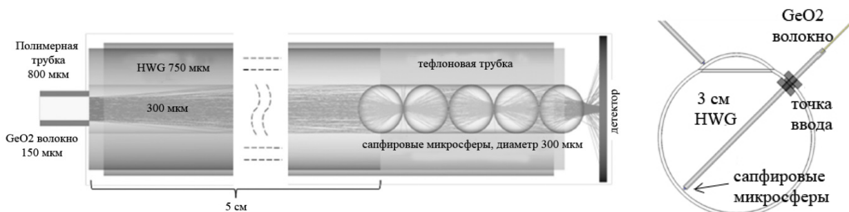
Рис. 4. Прототип 2,94 мкм «лазерного скальпеля» с использованием фокусирующих микросфер
