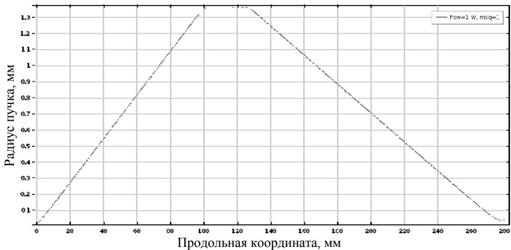
Рис. 4. Каустика пучка при моделировании без учета тепловой линзы
