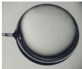
Рис. 4.1. Начало конденсации T_A = 16,05 К, T_B = 16,97 К
