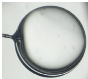
Рис. 6.1. Начало конденсации T_A = 16,5 \text{ К}
