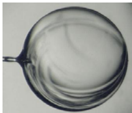
Рис. 4.2. Начало кристаллизации T_A = 15,81 К, T_B = 16,74 К
