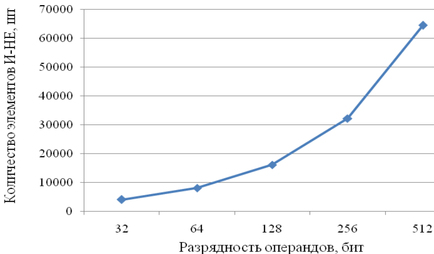
Рис. 6. График зависимости аппаратной сложности от разрядности операндов
