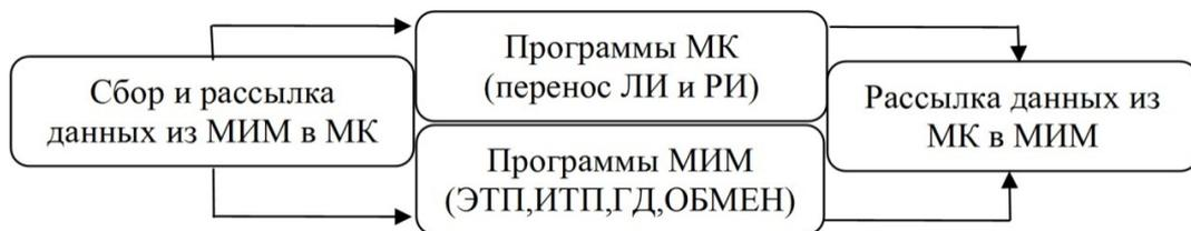
Рис. 2. Блок-схема работы модифицированной программы МИМОЗА-НДЗД на одном счетном шаге по времени
