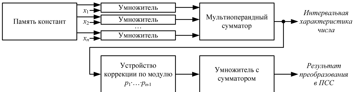
Рис. 7. Организация преобразователя кодов из СОК в ПСС
