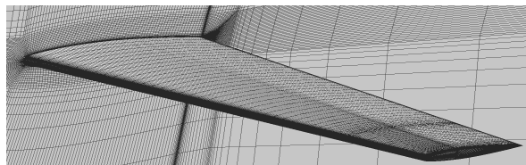
3D-расчет стационарных АДХ крыла: тест ONERA M6, обтекание вязким турбулентным газом, модель турбулентности – SA; расчетная сетка : \sim 1,9 млн. ячеек. Число неизвестных и размер СЛАУ \sim 10 млн.
