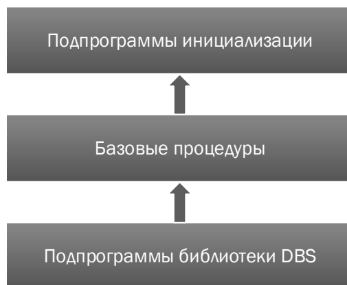
Рис. 5. Иерархия подпрограмм для работы с объектами DBS в Логос-Прочность
