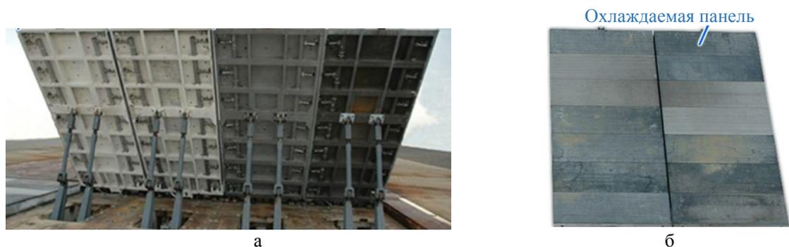
Рис. 1. ГО с системой водяного охлаждения на палубе авианосцы [0]: а – вид со стороны системы охлаждения; б – вид со стороны лицевой поверхности ГО
