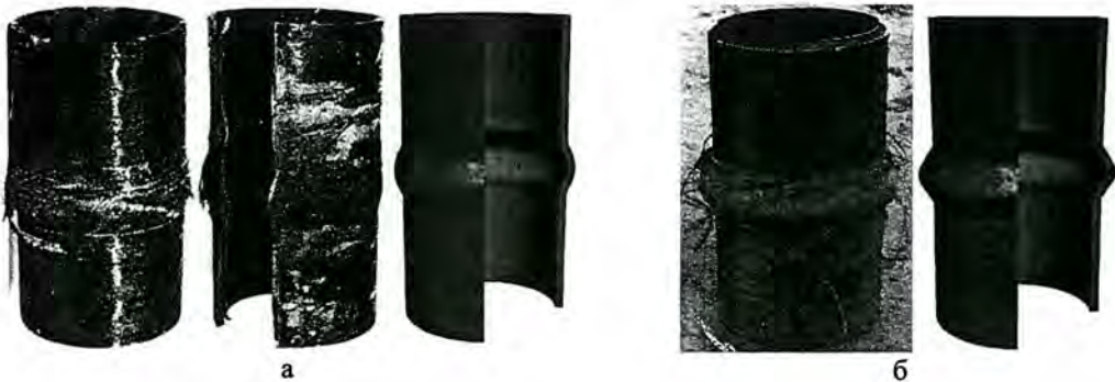
Рис. 4. Остаточные формы базальтопластиковой оболочки (эксперимент, расчет) после нагружения взрывом заряда ВВ массой 81 г (а) и 633 г (б)
