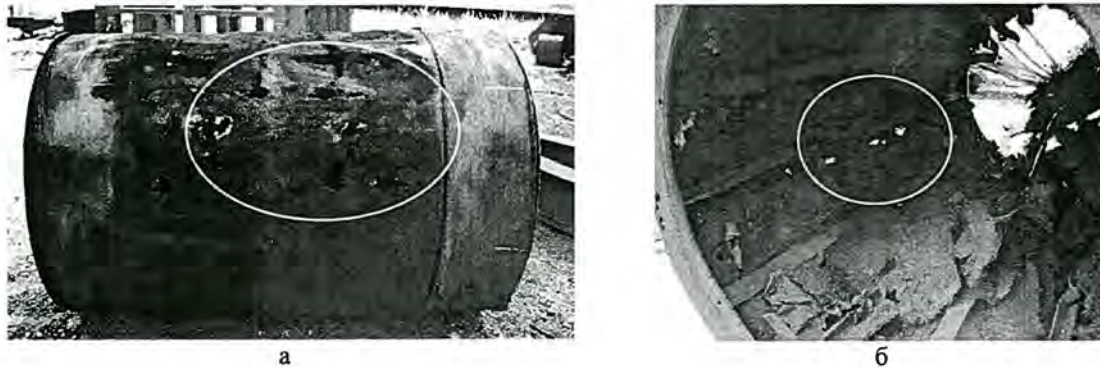
Рис. 9. Вид на противоосколочный экран: а – снаружи; б – изнутри (отмечена зона напротив повреждения базальтопластика)
