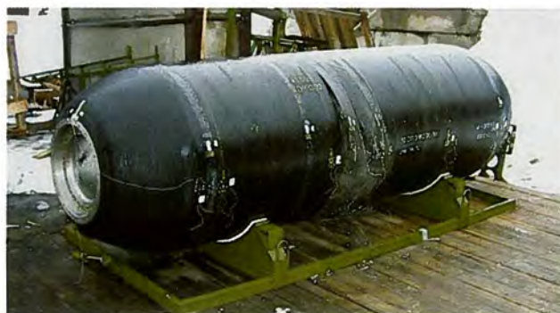
Второй экземпляр контейнера АТ595 после испытания (вид с противоположных сторон)
