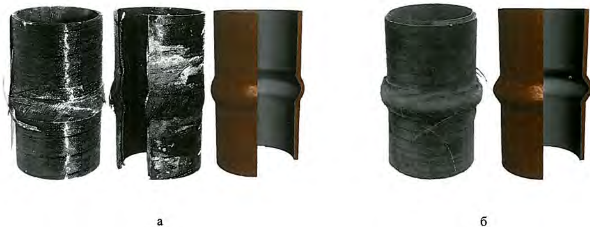
Остаточные формы базальтопластиковой оболочки (эксперимент, расчет) после нагружения взрывом заряда ВВ массой 81 г (а) и 633 г (б)
