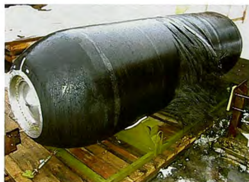
Второй экземпляр контейнера АТ595 после испытания (вид с противоположных сторон)
