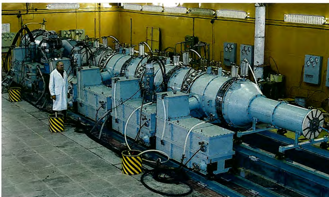
Общий вид макета ЛИУ-Р, зафиксированный в процессе пробной сборки установки
