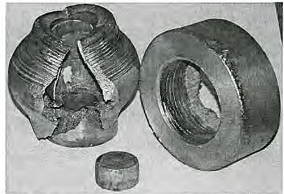
Рис. 6. Фотография взрывного устройства с варьируемой плотностью взрывчатого вещества (после испытания)
