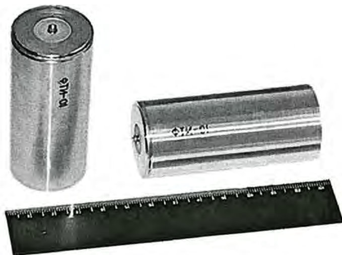
Рис. 1. Твердотельная фтор-ионная батарея
