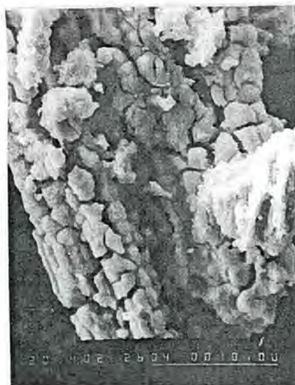
Рис. 3. Частицы с развитой структурой трещин
