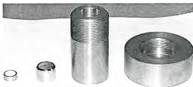
Рис. 5. Фотография взрывного устройства с варьируемой плотностью взрывчатого вещества в разобранном состоянии (до испытания)
