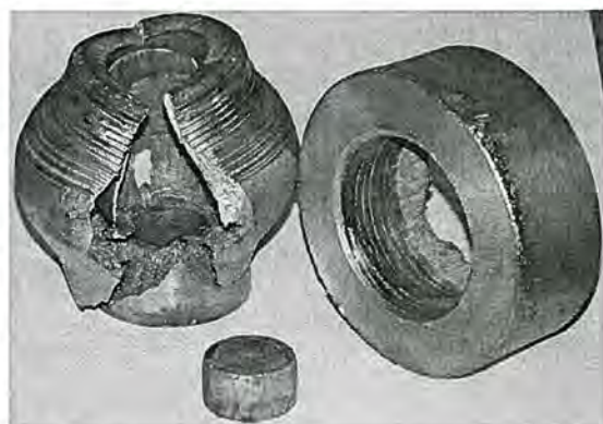
Рис. 6. Фотография взрывного устройства с варьируемой плотностью взрывчатого вещества (после испытания)
