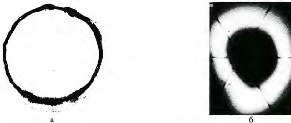
Рис. 5. Автографы трубчатого электронного пучка на выходах из инжектора (а) и на мишени ускорителя ЛИУ-30 (б) (Средний диаметр пучка \sim 0,25 м, амплитуда тока \sim 100 кА)
