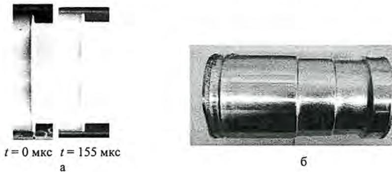
Рис. 4. Снимки лайнерных ПУ: а – рентгеновские снимки ПУ в R-D-0; б – фотография ПУ после эксперимента R-D-1
