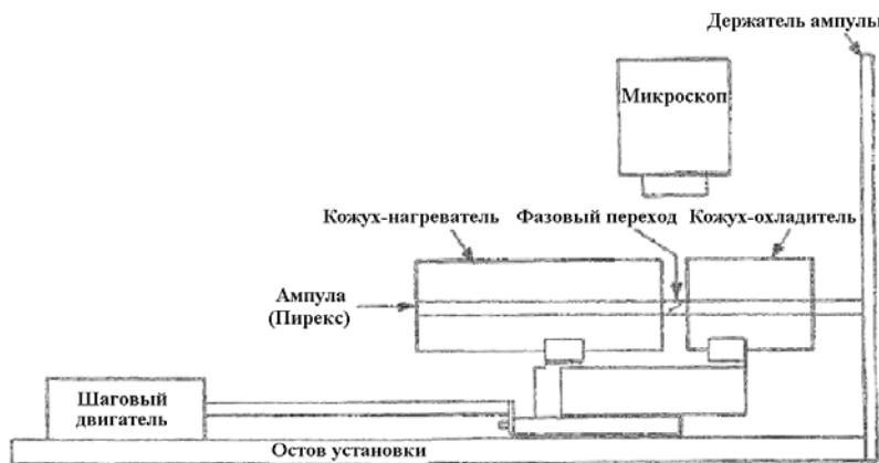
Рис. 9. Схема установки Бриджмена
