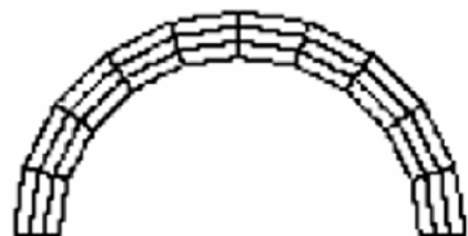
Рис. 9. Двумерная четырехугольная сетка
