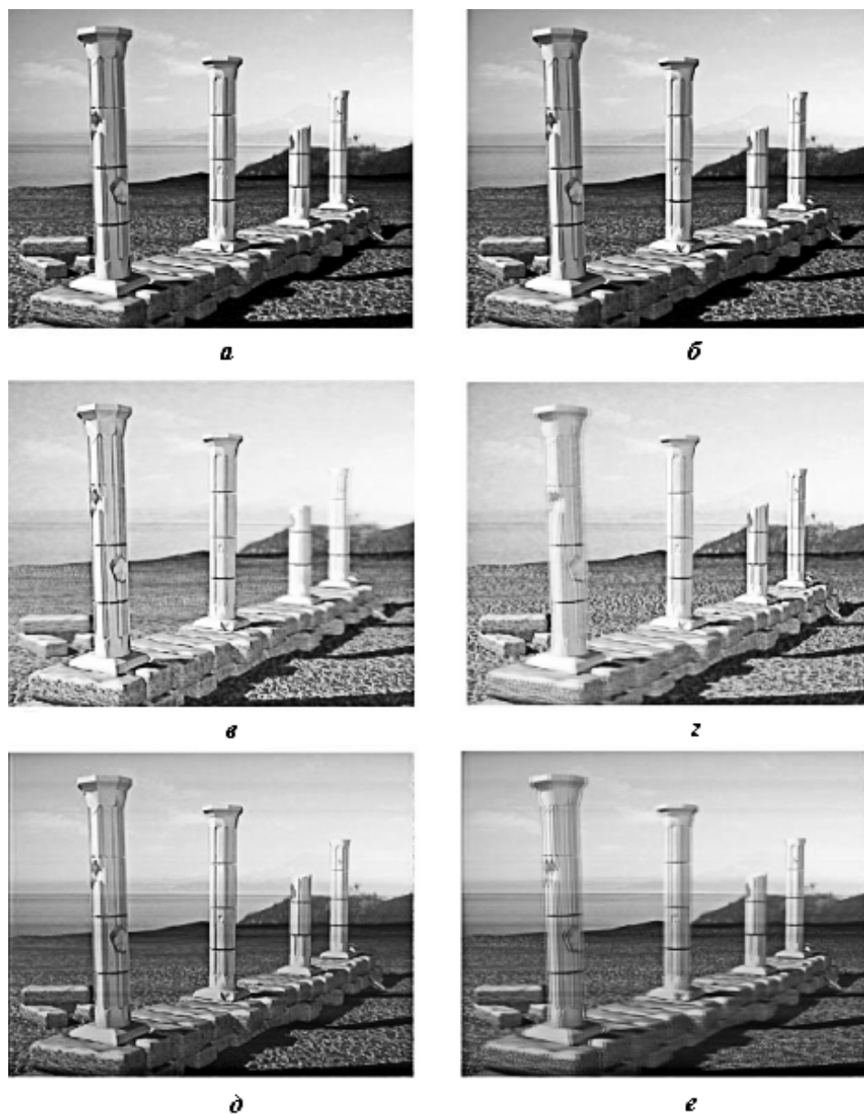
Рис. 6. Результаты численного эксперимента для стереодисплея: а, б — исходная стереопара; в, г — изображения, выводимые на ближний и тыльный экраны, рассчитанные с использованием нейросети; д, е — изображения для ближнего и тыльного экранов, полученные с помощью метода регуляризации Тихонова
