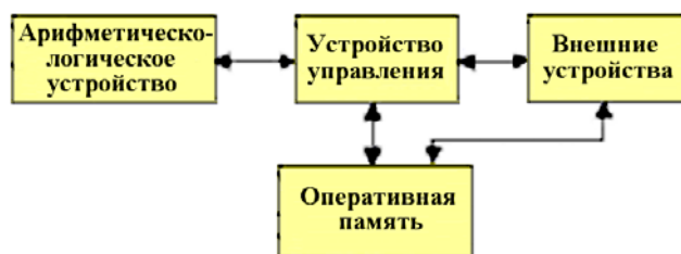
Рис. 5. Устройство компьютера согласно принципам фон Неймана
