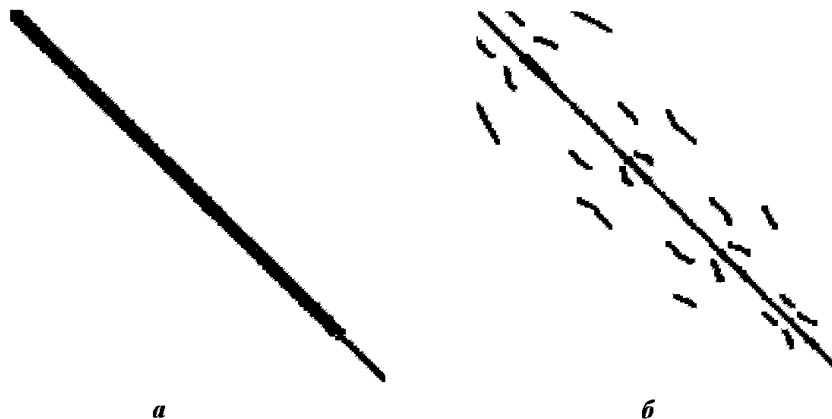
Рис. 21. Структура матрицы: a — скалярный режим; б — параллельный режим (4 процессора, одномерная декомпозиция полосы )
