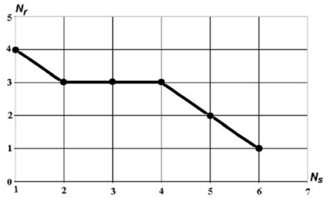
Рис. 1. Изменение характера сложности линейных систем в процессе одного шага по времени решения уравнения теплопроводности
