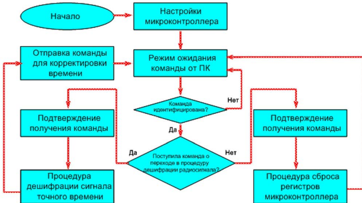
Рис. 3. Блок-схема алгоритма работы управляющей программы ВСТВ
