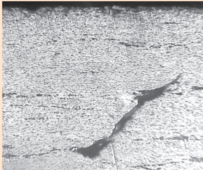
Внутренний откол в дюралюминии при множественном ударе стальных шариков диаметром 5 мм со скоростью 1400 м/с (длина трещины 300 мкм)
