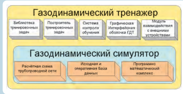
Типовая компоновочная схема газодинамического тренажера трубопроводных сетей
