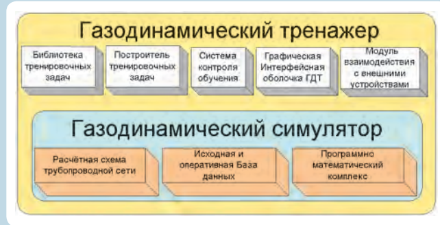
Типовая компоновочная схема газодинамического тренажера трубопроводных сетей
