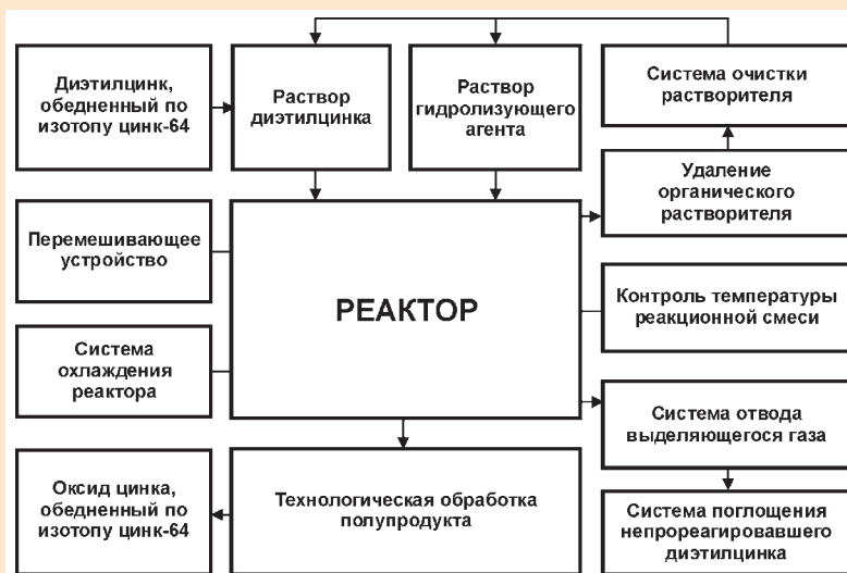
Схема технологического процесса по переработке диэтилцинка, обедненного по изотопу цинк-64, в оксид цинка
