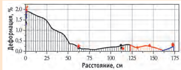
Расчетные и экспериментальные данные по деформации на наружной поверхности корпуса контейнера при взрыве заряда ВВ 8 кг ТНТ в инертной упаковке массой 36 кг
