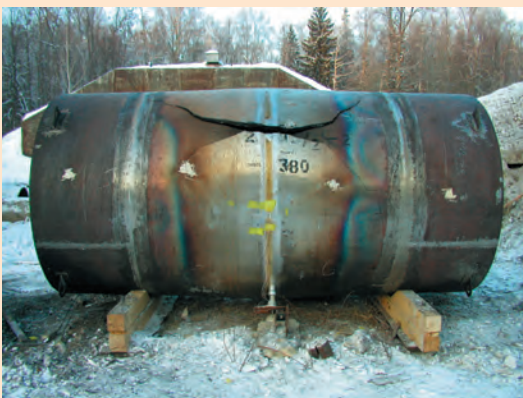
Конечное состояние цилиндрической трубы в эксперименте и расчете
