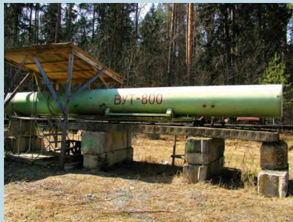
Испытание УПК на воздействие воздушной ударной волны и волны разрежения
