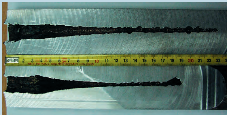
Каверны в стальной преграде, пробитые кумулятивными зарядами с ВС ГАМА (вверху) и ОМА (внизу)
