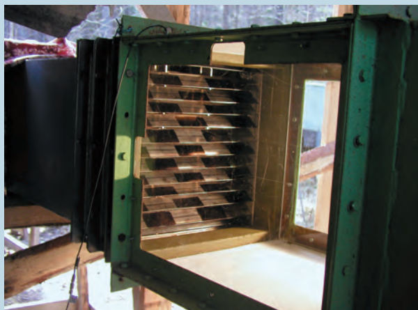
Испытание УПК на воздействие воздушной ударной волны и волны разрежения
