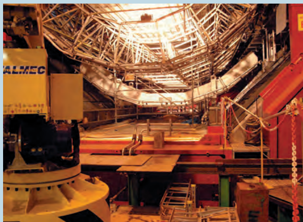
Рама спектрометра внутри магнита L3 на рабочей позиции
