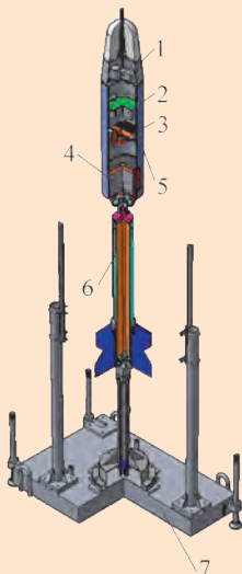
Ракетный комплекс и его элементы: 1 — система автоматики; 2 — приеморегистрирующая аппаратура; 3 — ретрансляционная аппаратура; 4 — парашютная система сохранного приземления; 5 — приборный отсек; 6 — ракетный двигатель; 7 — пусковая установка
