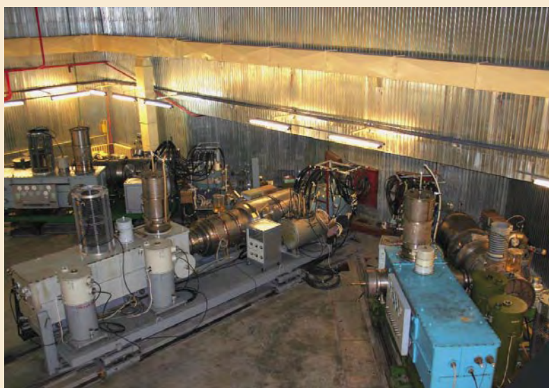
Рентгенографический комплекс РГК-Б. Центральный зал с тремя рентгеновскими установками БИМ234.3000
