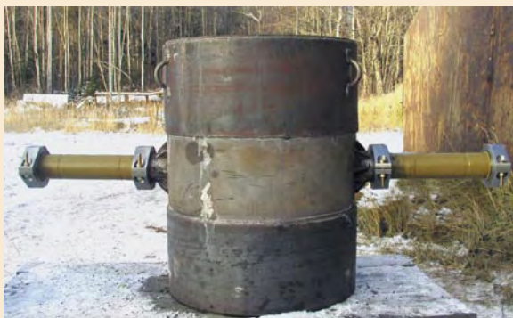
Камера после испытания взрывом мощностью 1,35 кг ТЭ
