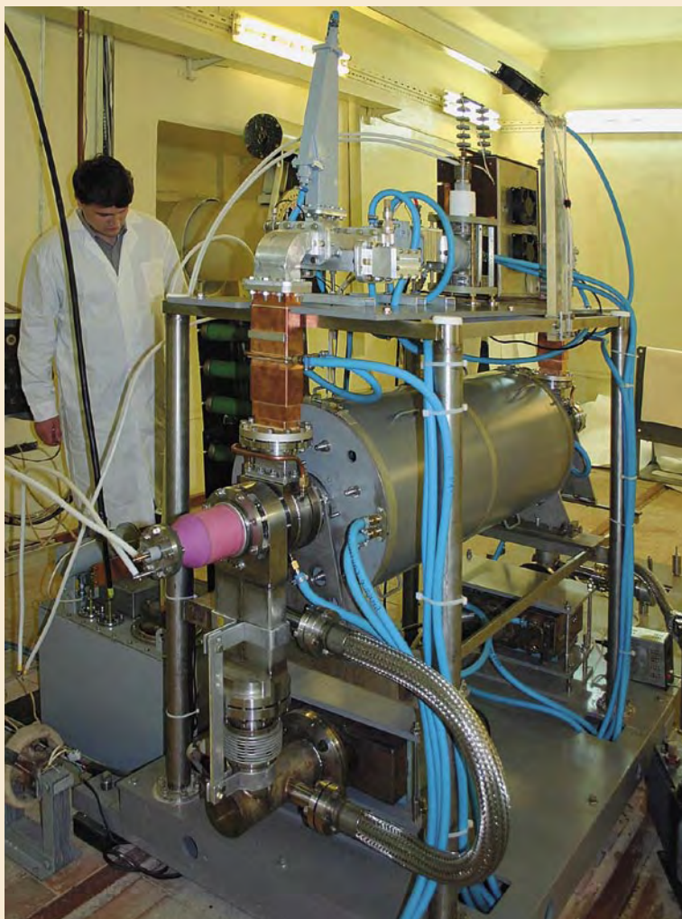
Излучающий модуль ускорителя, собранного на транспортировочной платформе
